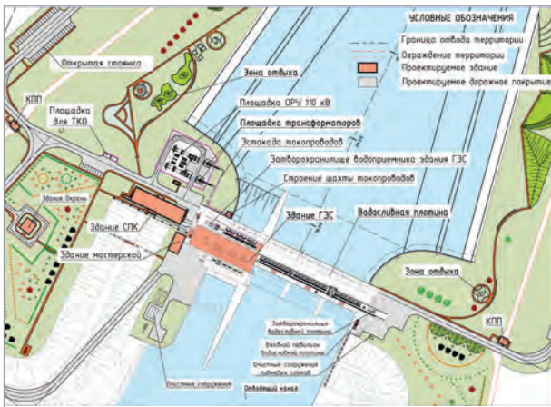
Рис. 2. Комплекс гидротехнических сооружений, обеспечивающий дополнительное обводнение Волго-Ахтубинской поймы. Авторский коллектив АО «Мособлгидропроект», ПАО «Русгидро»
